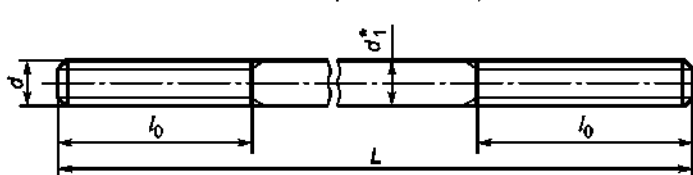
Рисунок 2 — Конструкция и размеры шпилек, лист 1
